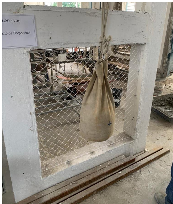
Foto n.º 01 – Visualização do ensaio de resistência ao impacto
